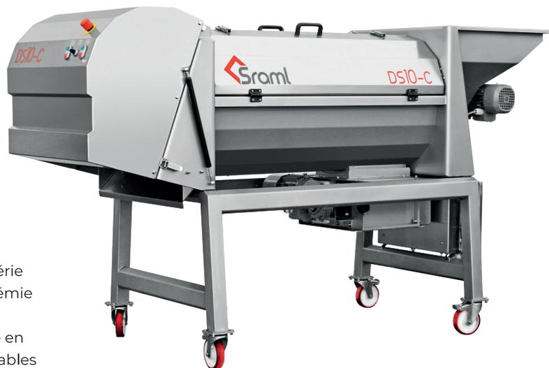
Disponible avec un fouloir coulissant en ligne, la série d'égrappoirs SRAML de type DS comprend une trémie de chargement et une vis sans fin à commande mécanique pour alimenter les raisins dans la cage en PVC à égrapper, des embouts en caoutchouc réglables en longueur et en inclinaison sur l'arbre d'égrappage et un variateur de vitesse électronique pour contrôler la rotation de la cage et de l'arbre.
