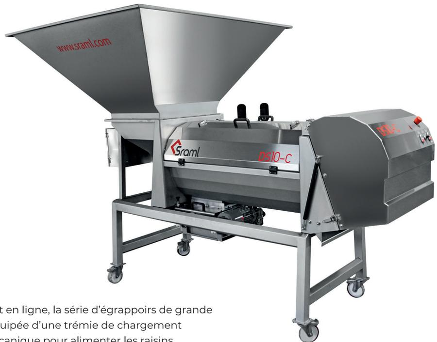
Disponible avec un fouloir coulissant en ligne, la série d'égrappoirs de grande capacité SRAML de type DSH est équipée d'une trémie de chargement et une vis sans fin à commande mécanique pour alimenter les raisins dans la cage en PVC à égrapper, des embouts en caoutchouc réglables en longueur et en inclinaison sur l'arbre d'égrappage et un variateur de vitesse électronique pour contrôler la rotation de la cage et de l'arbre.
