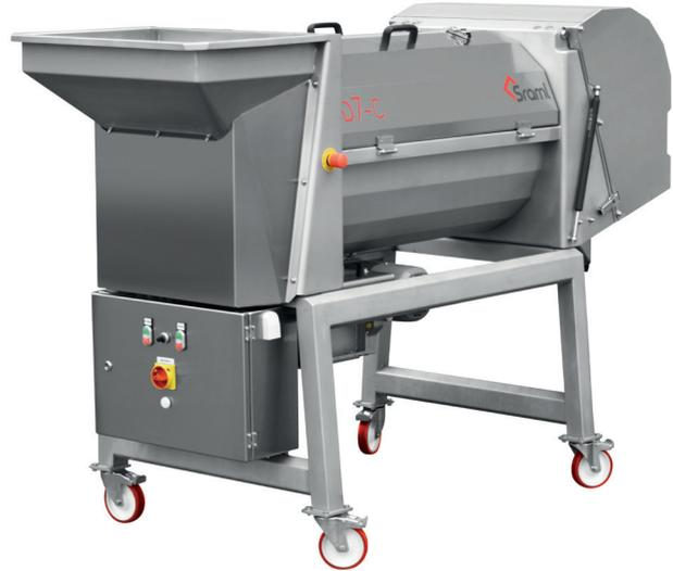
Disponible avec le fouloir coulissant en ligne, la série d'égrappoirs SRAML de type D est équipée d'une trémie de chargement, d'une cage en PVC perforée, d'embouts en caoutchouc réglables en longueur et en inclinaison sur l'arbre d'égrappage et d'un variateur électronique de vitesse pour contrôler la rotation de la cage et de l'arbre.
